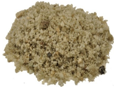
Struska vysokopeční - granulovaná
