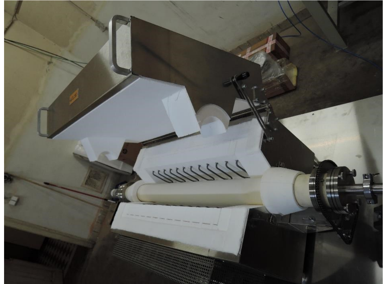
Rotační trubice s tepelným těsněním umístěna v peci s bočními topnými spirálami.
