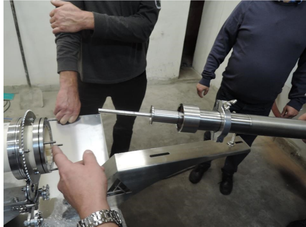
Detail na sondu zapařtěnou v patroně pro výstup plynů z patrony a pro analýzu.
