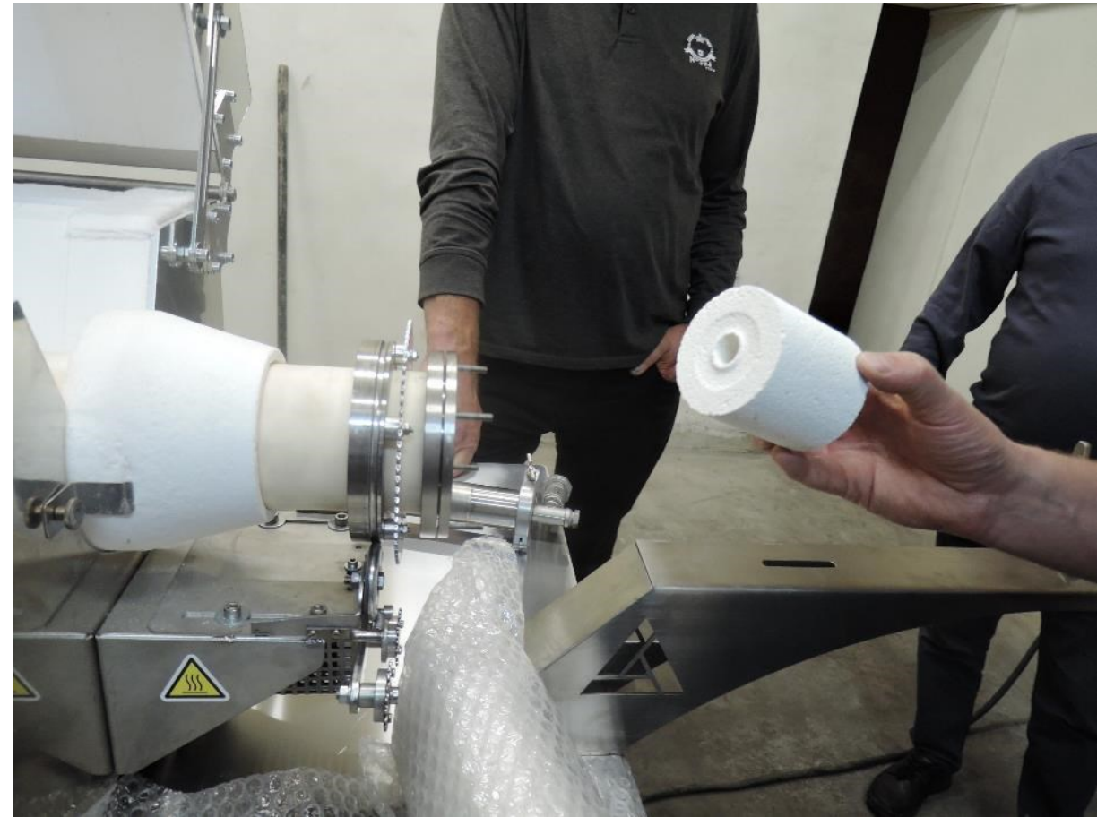
Těsnění patrony proti pohybu v trubce.
