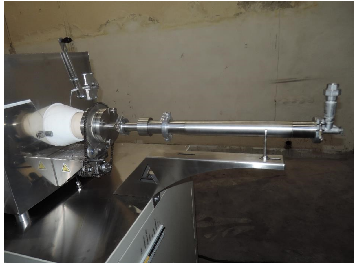
Pravá část – pohon otáčení, odvod plynů, rozebíratelný chladič, bezpečnostní ventil a přípojně místo pro analyzátor plynů.
