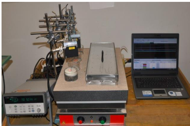
80 g vzorku, frakce 1 – 3mm teplota pískové lázně 80°C
