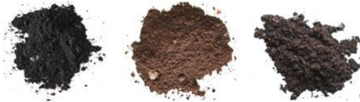
okuje originální okuje kalcinované na 700°C okuje kalcinované na 900°C
