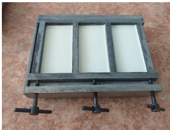
Nerezová forma s tenkou vrstvou tuhnutí směsi bílého cementu s TEX3
