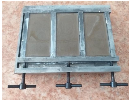
Směs Portlandského cementu a strusky aplikovaná na vrstvu fotoaktivního materiálu
