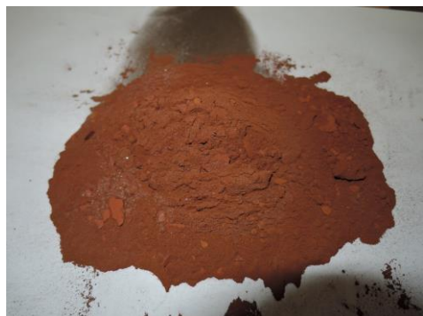
RP08, Kal OC po 800°C, atmosféra N + Grafít
